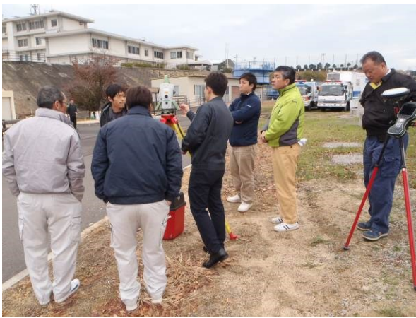
写真-16 地上型レーザースキャナー (トータルステーション機能付)の演習 ※ [講師] ライカジオシステムズ㈱
