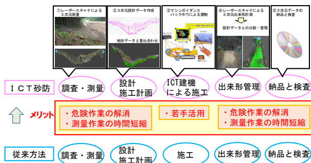
図-2 ICT砂防のメリット(丁字ヶ谷第2号堰堤)
