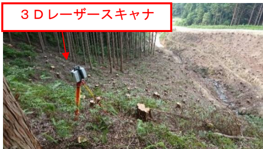
写真-2 3DLSによる3次元データ取得状況
