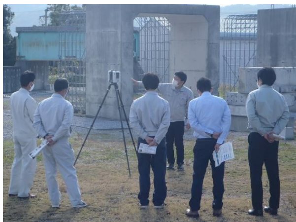
写真-4 出来形計測実習(TLS)
