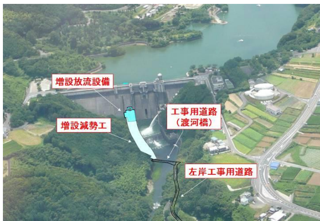
図-4 野村ダム堰堤改修事業（イメージ）
