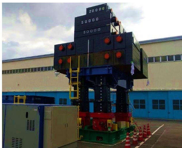
写真3:TD-2702(せり上げ能力:270トン)
