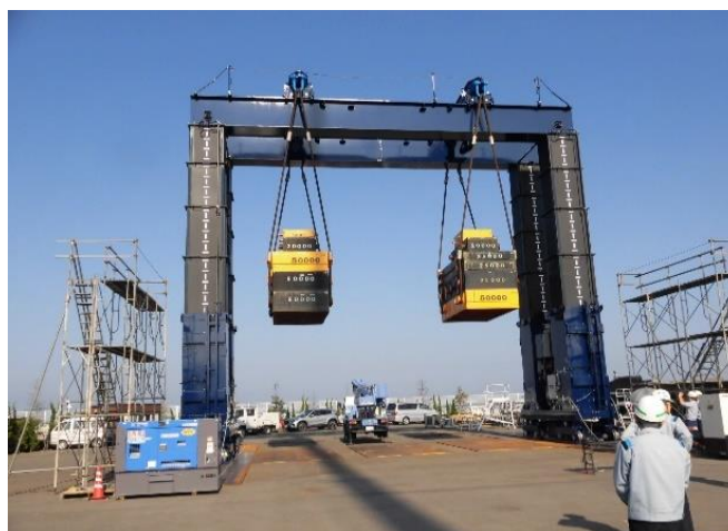
写真1：TB-3000W(せり上げ能力 300トン)
