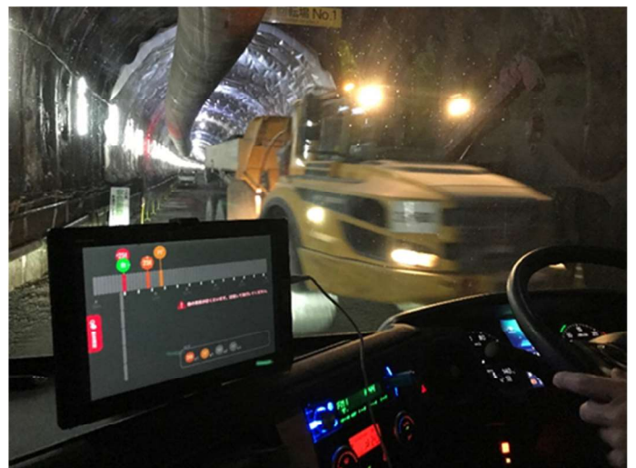
写真-2 運転席のタブレット設置状況
