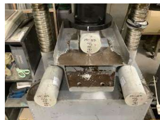
FD-15 投入攪拌状況と割裂引張強度試験
