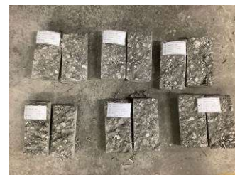
FD-15 投入攪拌状況と割裂引張強度試験
