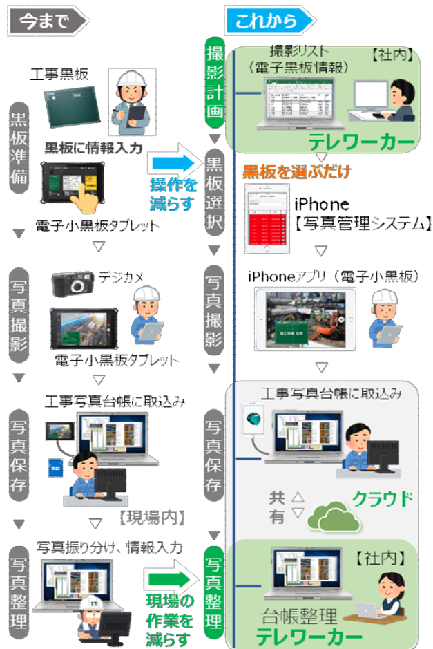
図-4 工事写真管理システム概要
