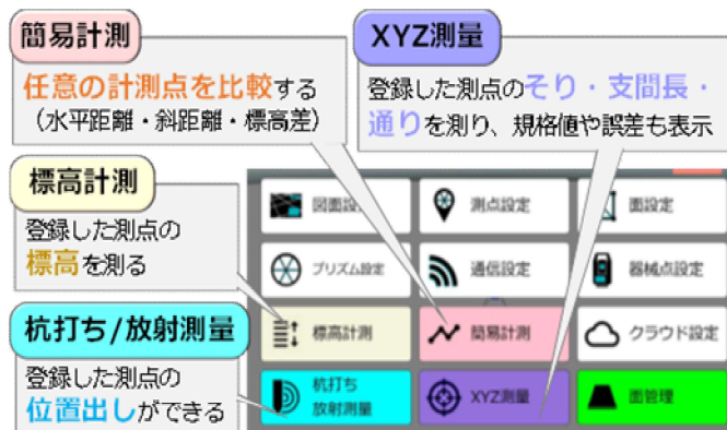
図-3 ワンマン測量システムの機能
