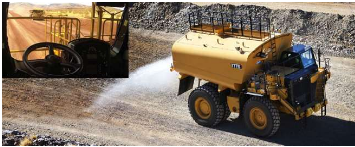
無人で散水する自律運転の大型散水車
