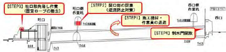
図-9 施工中通水の実施手順
