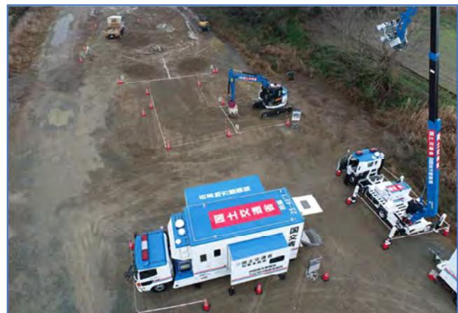
遠隔操縦式バックホウ操作訓練
