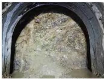
写真-6 切羽の状況と亀裂抽出画像
