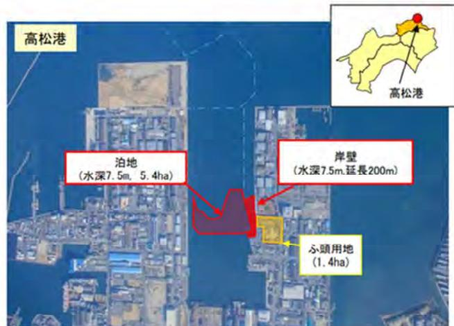
整備事業の一環として、新造船の大型フェリー係留のための係船柱を備える新岸壁の船首尾の築造を行った。施工は供用中のフェリー（1日4便就航）に極めて近接した場所で行われ、施工期間を通して制約の多い工事であった。また新造フェリーの就航予定時期が決まっており、指定工期遵守が必至の中で、想定外に発生した課題への対応を余儀なくされたため、工程的にも非常に厳しい工事となった。
