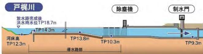
図-5 新日下川放水路呑口側縦断図
